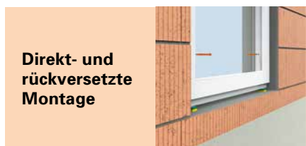
In der Laibung 0-40 mm an/über der Laibungskante
