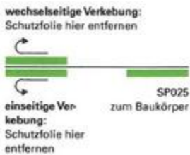
Bild 12: EW+ / EW = einseitig und wechselseitig: Selbstklebung kann sowohl wechselseitig als auch einseitig genutzt werden, je nachdem, auf welcher Seite die Abdeckung der Selbstklebung entfernt wird.
