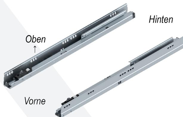
Vom oberen Boden benötigen Sie mindesten 31 mm + 3-5 mm = somit 34 bis 36 mm. Zeichnen Sie zuerst diese Befestigungspunkte an und montieren Sie dann die Auszüge.
