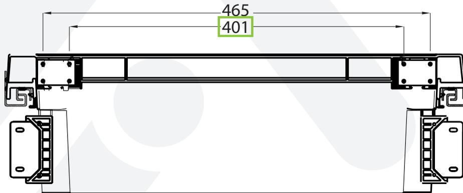
Für die oberen Löcher messen Sie von der Oberseite der Blende 12mm + Maß A (Maß A = Oberkante der Schublade + den Überstand den die Blende benötigt [bis zum Herd minus etwas Abstand]).
